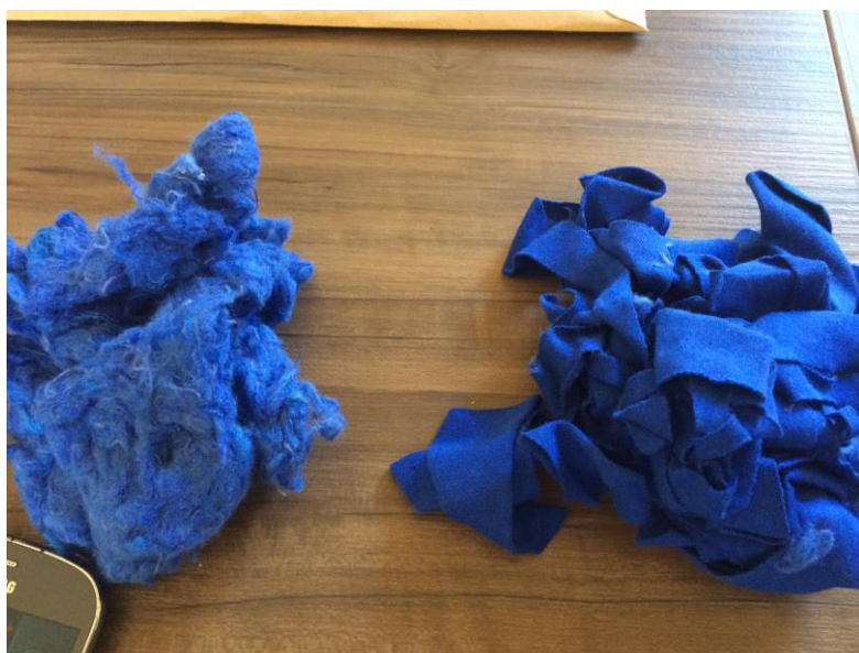
Figura 02 – À direita, como os resíduos são destinados para empresas transformadoras; à esquerda, os resíduos após o processo de desfibragem.
