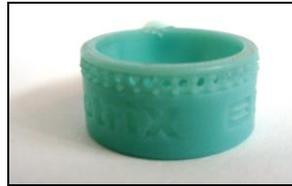
Figura 3 – Anel injetado em borracha para cravação de gemas.
